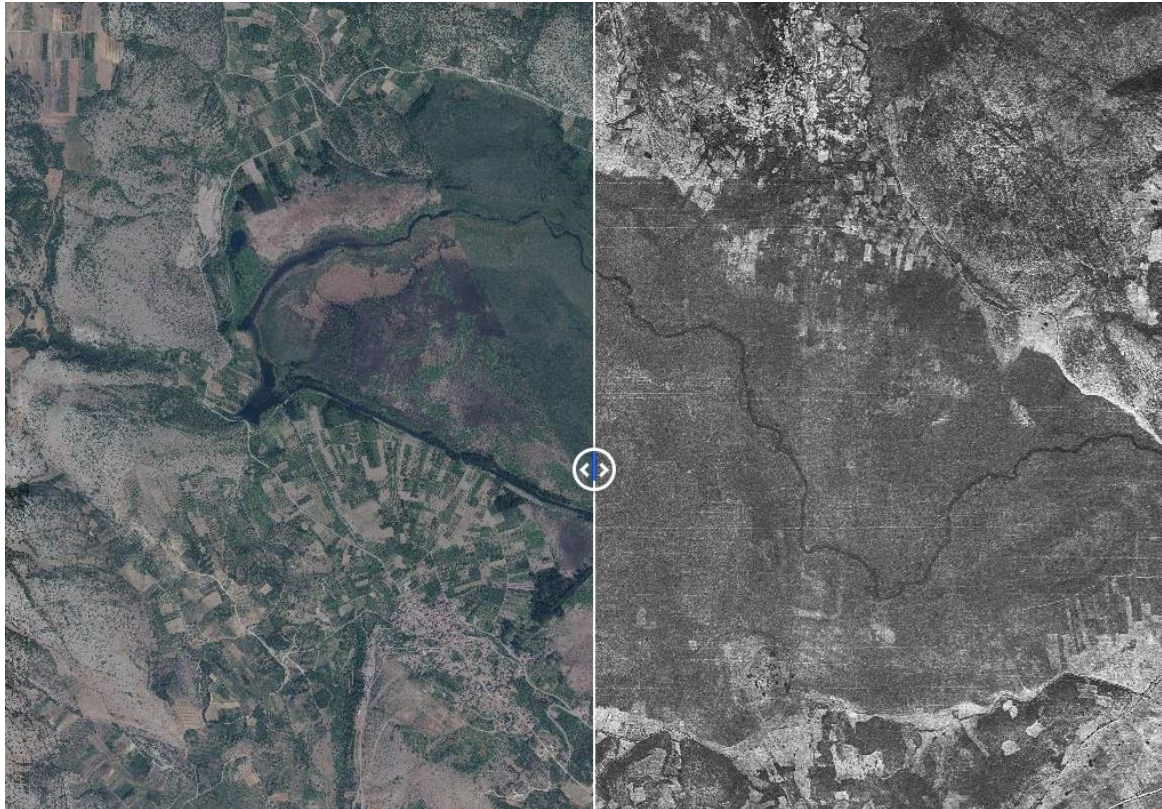
Εικόνα 4-15: Απεικόνιση της διευθέτησης με εκτροπή του π. Εδεσσαίου ανάντη του φράγματος υδροληψίας του ΥΗΣ Άγρα (σύγκριση με αεροφωτογραφίες του 1945-60 από το Κτηματολόγιο ΑΕ).
