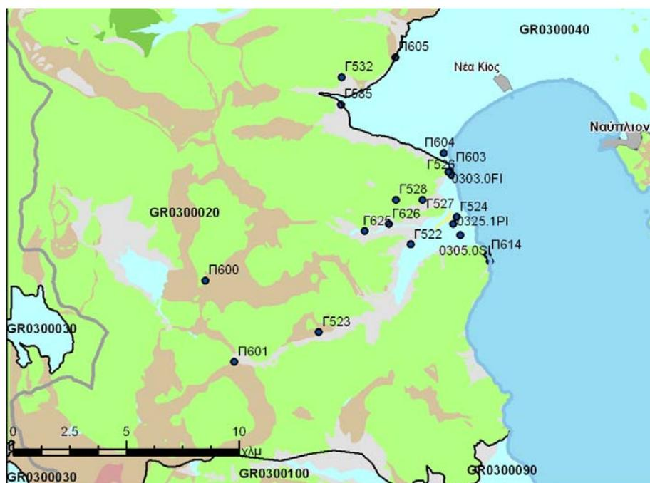
Σχήμα 2-1. Σημεία παρακολούθησης χημικής κατάστασης υπόγειου υδατικού συστήματος GR0300020 και λεπτομέρεια αυτού στην περιοχή των κύριων εκφορτίσεων
