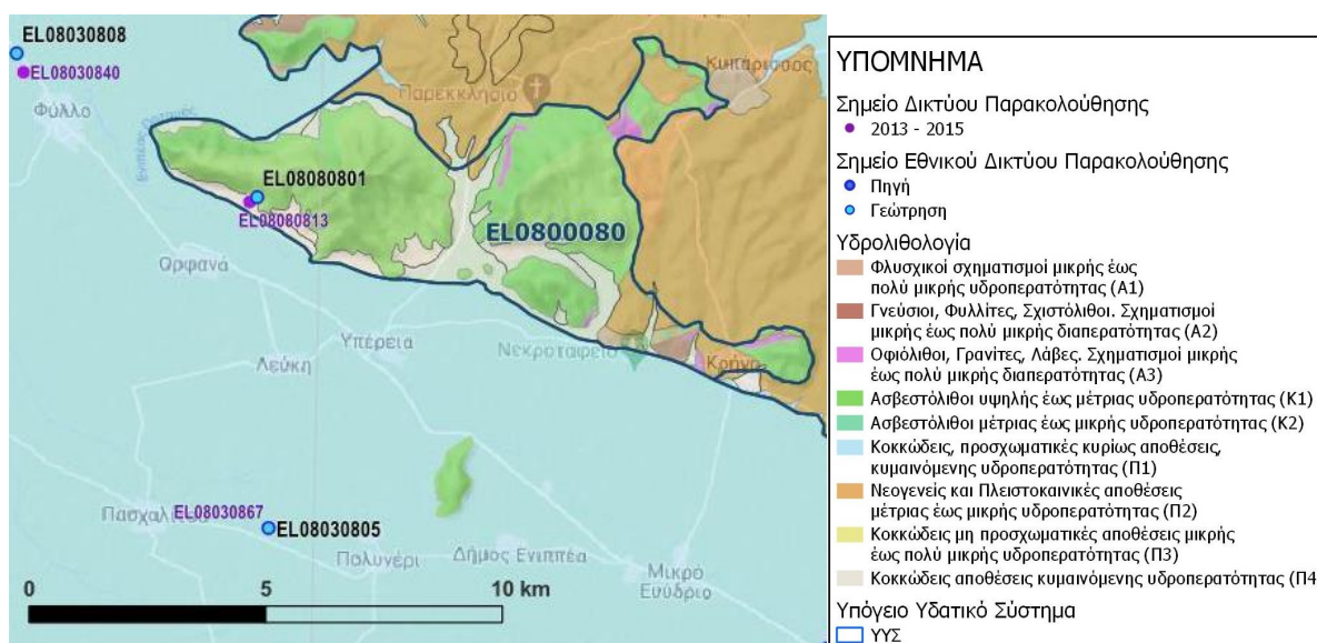
Εικόνα 6-38. Σημεία παρακολούθησης υπόγειου υδατικού συστήματος Φυλλήιου – Ορφανών (ΕΛ0800080)
