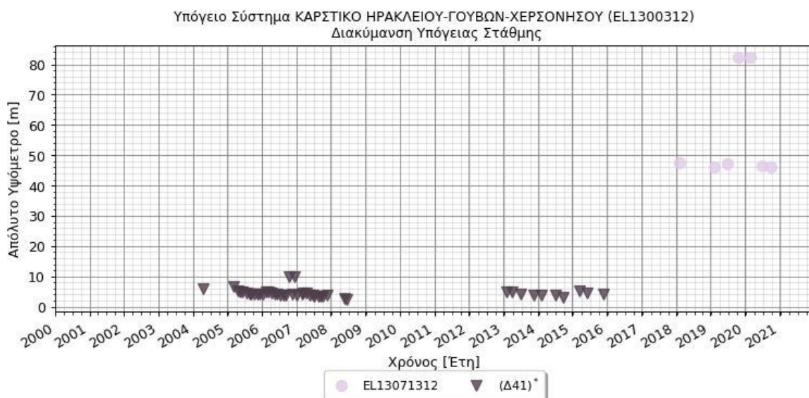
Σχήμα 6.30.6 Διάγραμμα διακύμανσης στάθμης γεωτρήσεων υπόγειου υδατικού συστήματος Παράκτιο Ηρακλείου – Γουβών - Χερσονήσου (EL1300312)
