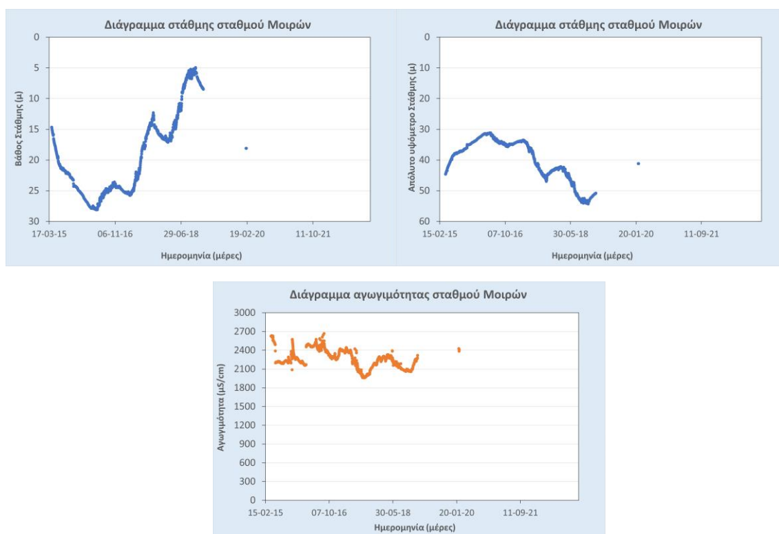
Σχήμα 7.8.13 Διαγράμματα μετρήσεων στάθμης υπόγειου νερού και μετρήσεων Ηλεκτρικής αγωγιμότητας για τον Αυτόματο Υδρολογικό σταθμό «Γ Ζώνη ΤΟΕΒ Μοιρών» όπως διατίθεται από την Αποκεντρωμένη Διοίκηση Κρήτης.
