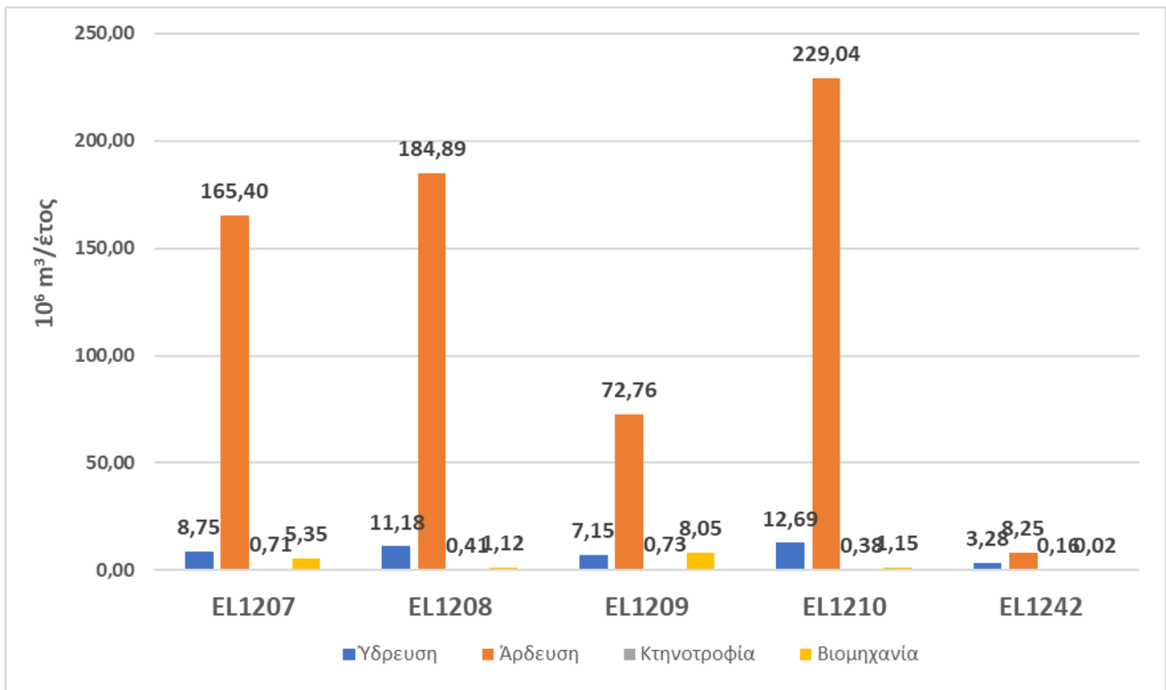
Σχήμα 4-15 Ποσότητες και κατανομή ετήσιων απολήψεων νερού στη ΛΑΠ Ρ. Κομοτηνής - Λουτρού Έβρου (EL1209)
