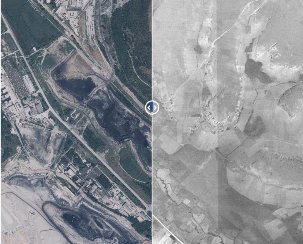
Εικόνα 4-26: Δορυφορική απεικόνιση του ΥΣ ΕΙ0902R0000010123Η - Ρ. Σουλού – Τμήμα εντός Ορυχείων με την εκτροπή της προϋπάρχουσας κοίτης (σύγκριση με αεροφωτογραφίες 1945-1960)
