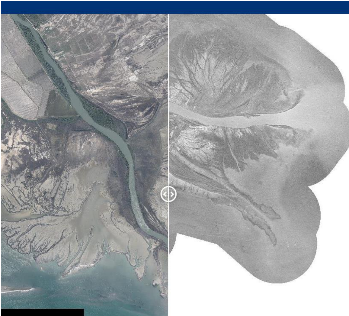
Εικόνα 4-5: Διευθέτηση του κατάντη τμήματος του π. Αλιάκμονα στην εκβολή στον Θερμαϊκό κόλπο (σύγκριση με αεροφωτογραφίες 1945 – 1960).
