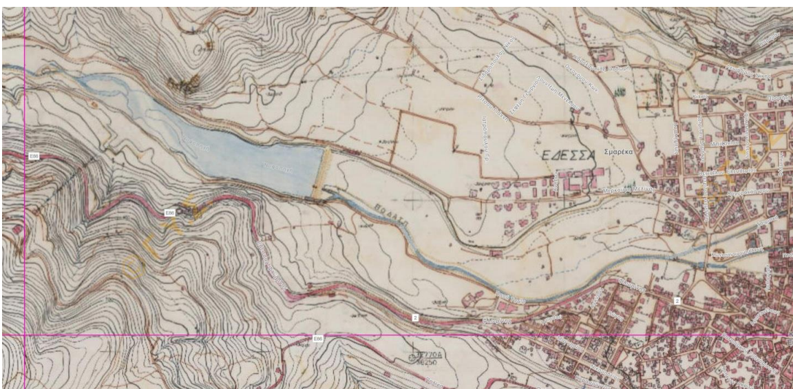
Εικόνα 4-14: Απεικόνιση της κοίτης του π. Εδεσσαίου κατάντη του ΥΗΣ Άγρα με το αναρρυθμιστικό ταμιευτήρα (Τοπογραφικό Διάγραμμα κλίμακας 1:5,000 της ΓΥΣ).
