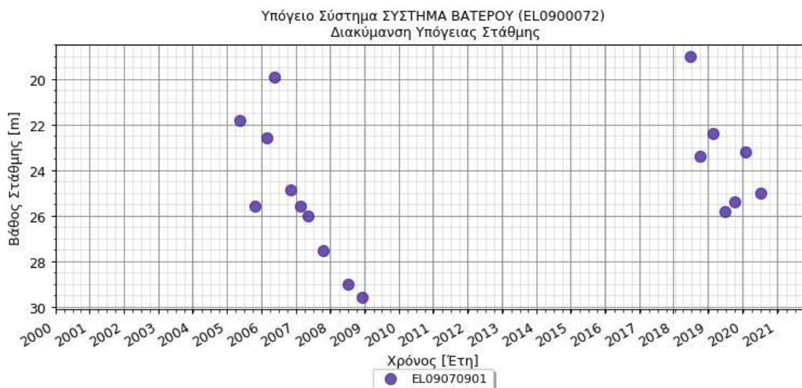
Σχήμα 7.10.3. Διάγραμμα διακύμανσης της στάθμης στις γεωτρήσεις του υπόγειου υδατικού συστήματος ΒΑΤΕΡΟΥ (ΕΛ0900072)
