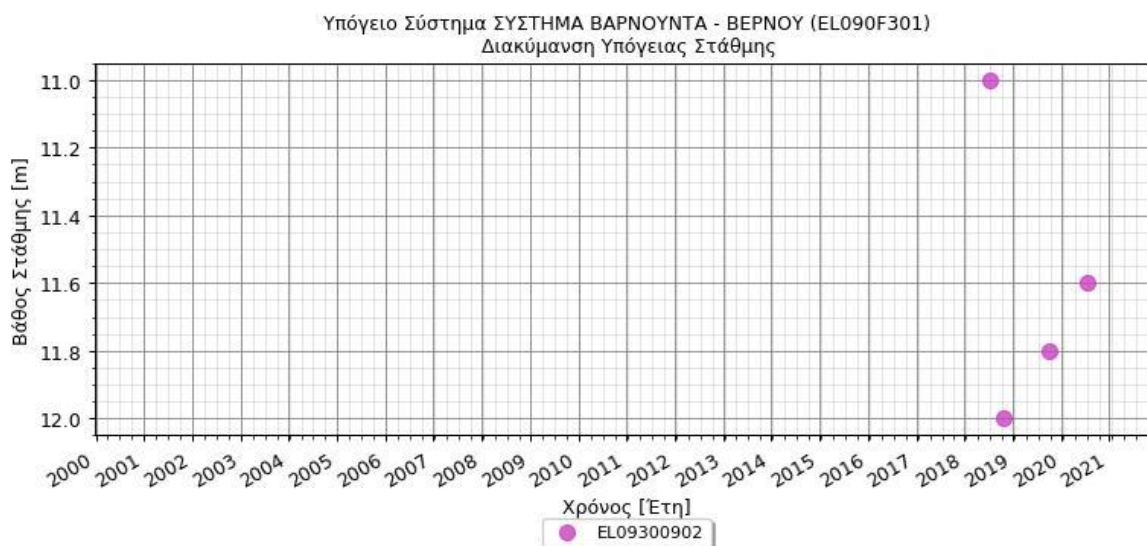
Σχήμα 7.37.3. Διάγραμμα διακύμανσης της στάθμης στις γεωτρήσεις του υπόγειου υδατικού συστήματος ΒΑΡΝΟΥΝΤΑ - ΒΕΡΝΟΥ (ΕΛ090F301)
