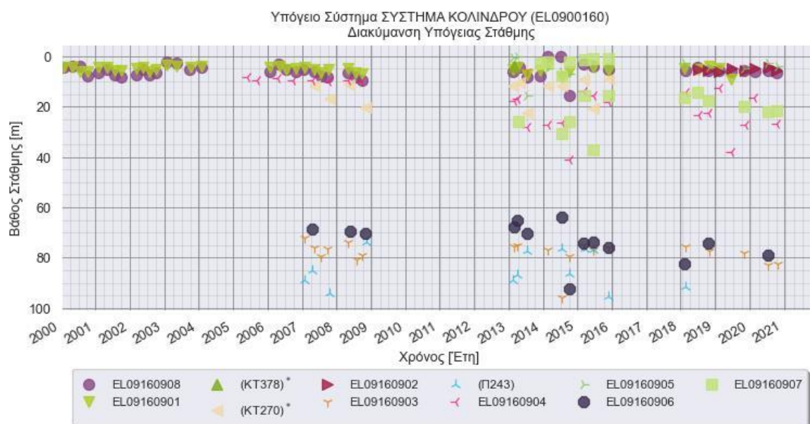
Σχήμα 7.26.9. Διάγραμμα διακύμανσης της στάθμης στις γεωτρήσεις του υπόγειου υδατικού συστήματος ΚΟΛΙΝΔΡΟΥ (ΕΛ0900160)
