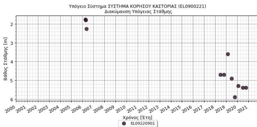
Σχήμα 7.30.3. Διάγραμμα διακύμανσης της στάθμης στις γεωτρήσεις του υπόγειου υδατικού συστήματος ΚΟΡΗΣΟΥ ΚΑΣΤΟΡΙΑΣ (ΕΛ0900221)
