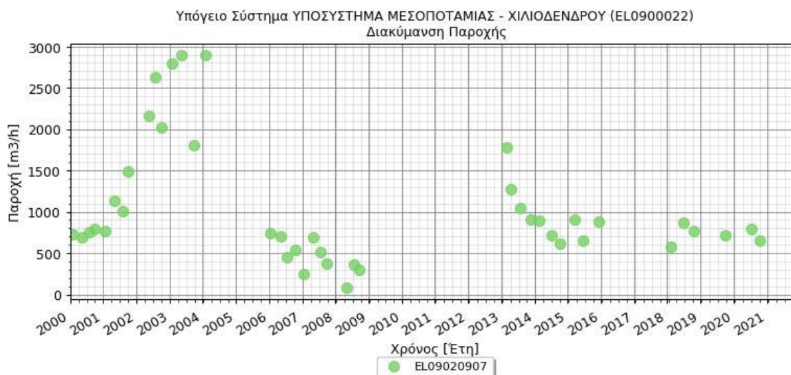
Σχήμα 7.2.7. Διάγραμμα διακύμανσης της παροχής στις πηγές του υπόγειου υδατικού συστήματος ΜΕΣΟΠΟΤΑΜΙΑΣ - ΧΙΛΙΟΔΕΝΔΡΟΥ (ΕΛ0900022)
