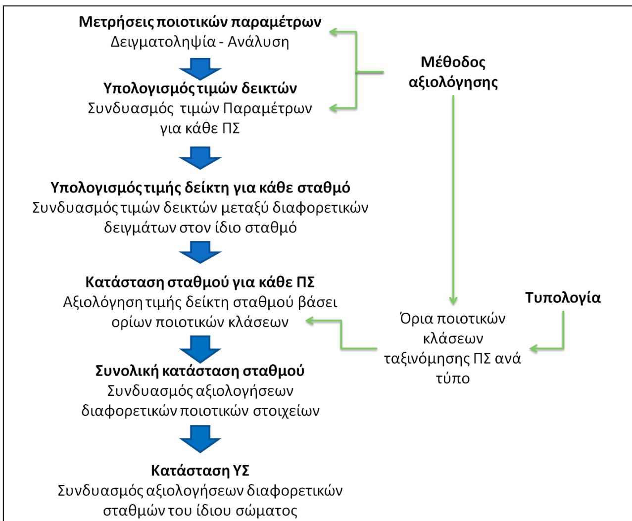
Σχήμα 4-1 Στάδια επεξεργασίας των δεδομένων παρακολούθησης μέχρι την ταξινόμηση της οικολογικής κατάστασης των επιφανειακών ΥΣ
