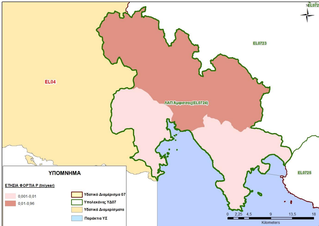
Χάρτης 11-19: Ετήσια φορτία P (tn/year) που παράγονται στη Λεκάνη Απορροής Άμφισσας (ΕΛ0724) από σημειακές πηγές ρύπανσης
