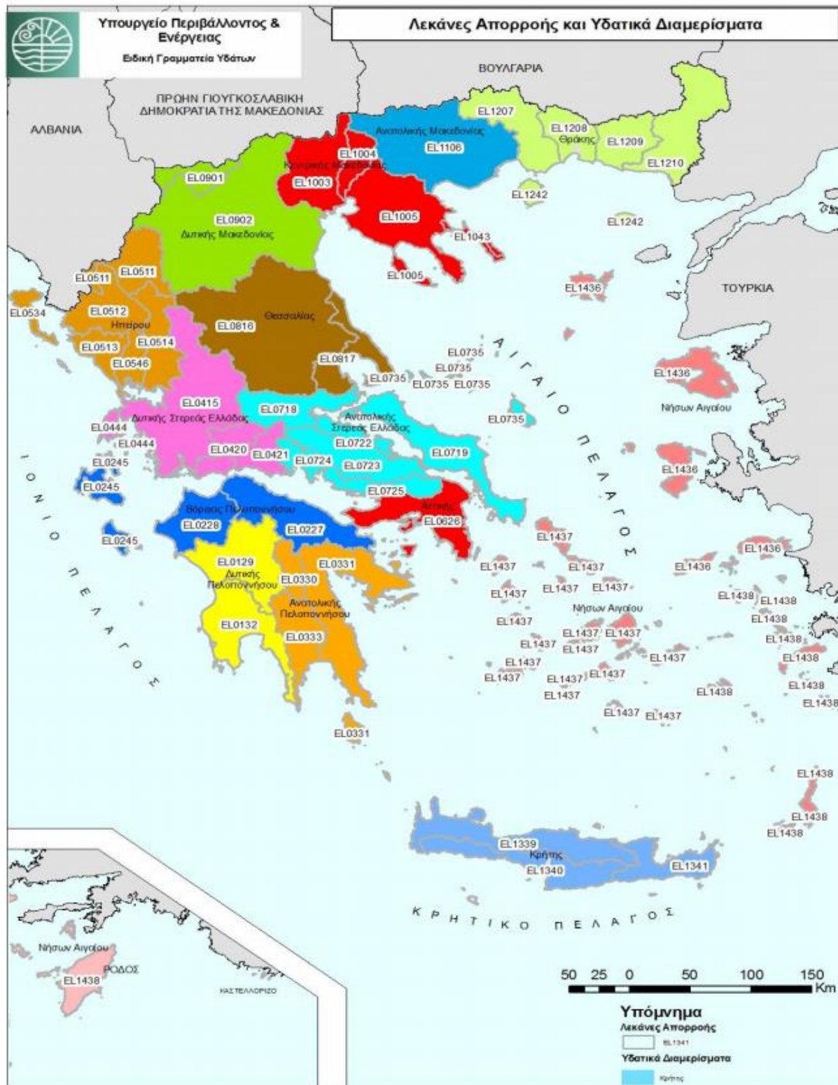
Σχήμα 2-1: Υδρολογική διαίρεση της χώρας σε υδατικά διαμερίσματα (ΠΛΑΠ) και Λεκάνες Απορροής Ποταμού (ΛΑΠ)
