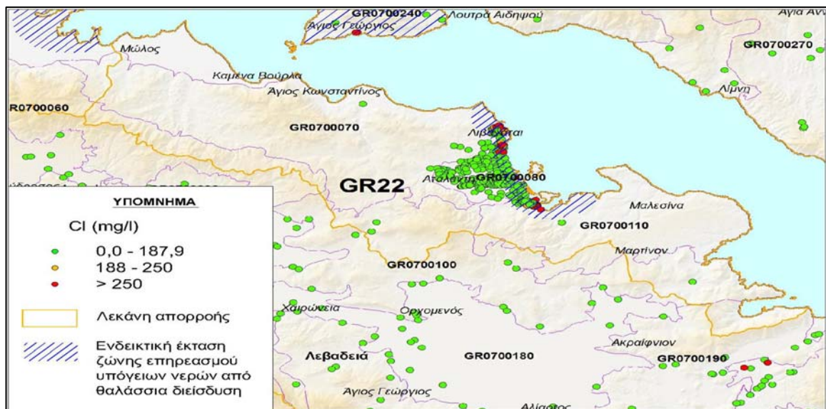
Σχήμα 8-2: Θέσεις μετρήσεων χλωριόντων στο υπόγειο νερό και ενδεικτική έκταση θαλάσσιας διείσδυσης στην ΛΑΠ ΒΑ/κής Παραλίας Καλλίδρομου (GR22)
