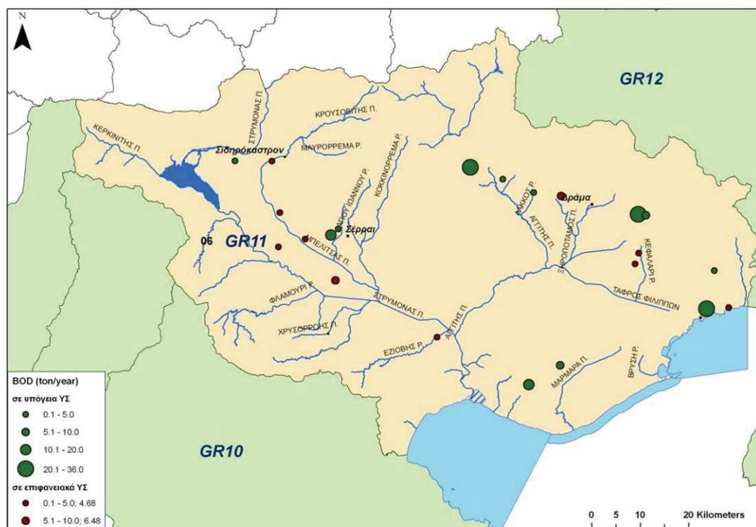
**ΣΧΗΜΑ 8.9.** ΕΤΗΣΙΟ ΦΟΡΤΙΟ BOD (ΤΝ/ΥΕΑΡ) ΠΟΥ ΚΑΤΑΛΗΓΕΙ ΣΤΑ ΕΠΙΦΑΝΕΙΑΚΑ ΚΑΙ ΥΠΟΓΕΙΑ ΥΣ ΑΠΟ ΤΗ ΒΙΟΜΗΧΑΝΙΚΗ ΔΡΑΣΤΗΡΙΟΤΗΤΑ
