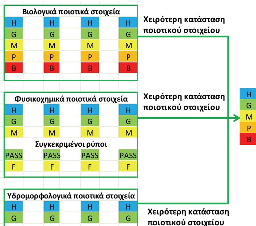
**ΣΧΗΜΑ 9.6:** ΣΧΗΜΑΤΙΚΗ ΑΠΕΙΚΟΝΙΣΗ ΤΟΥ ΤΡΟΠΟΥ ΜΕ ΤΟΝ ΟΠΟΙΟ ΣΥΝΔΥΑΖΟΝΤΑΙ ΟΙ ΔΙΑΦΟΡΕΤΙΚΕΣ ΟΜΑΔΕΣ ΠΟΙΟΤΙΚΩΝ ΣΤΟΙΧΕΙΩΝ ΓΙΑ ΤΗΝ ΤΑΞΙΝΟΜΗΣΗ ΤΗΣ ΟΙΚΟΛΟΓΙΚΗΣ ΚΑΤΑΣΤΑΣΗΣ. Η=ΥΨΗΛΗ ΚΑΤΑΣΤΑΣΗ, G=ΚΑΛΗ ΚΑΤΑΣΤΑΣΗ, M= ΜΕΤΡΙΑ ΚΑΤΑΣΤΑΣΗ, P=ΕΛΛΙΠΗΣ ΚΑΤΑΣΤΑΣΗ, B= ΚΑΚΗ ΚΑΤΑΣΤΑΣΗ. PASS= ΣΗΜΑΙΝΕΙ ΚΑΛΗ Η ΥΨΗΛΗ ΚΑΤΑ ΠΕΡΙΠΤΩΣΗ ΓΙΑ ΤΗΝ ΟΙΚΟΛΟΓΙΚΗ ΚΑΤΑΣΤΑΣΗ Η ΤΟ ΔΥΝΑΜΙΚΟΥ ΤΩΝ ΕΠΙΦΑΝΕΙΑΚΩΝ ΥΣ, F= ΚΑΤΩΤΕΡΗ ΤΗΣ ΚΑΛΗΣ/ΜΕΤΡΙΑ.
