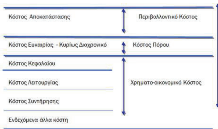
Εικόνα 10-1. Οι κατηγορίες κόστους υπηρεσιών ύδατος σύμφωνα με την Οδηγία 2000/60/ΕΚ. Πηγή: WATECO, 2002 38 .
